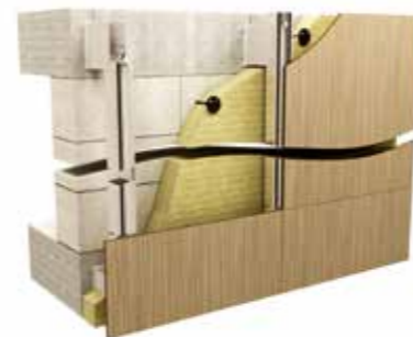
Mocowanie płyt HPL za pomocą systemu klejenia
